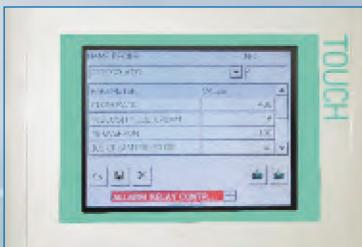
FRENCH Écran tactile « Touch screen », page de programmation et réglage des valeurs de production désirées et fonction d'autodiagnostic.
